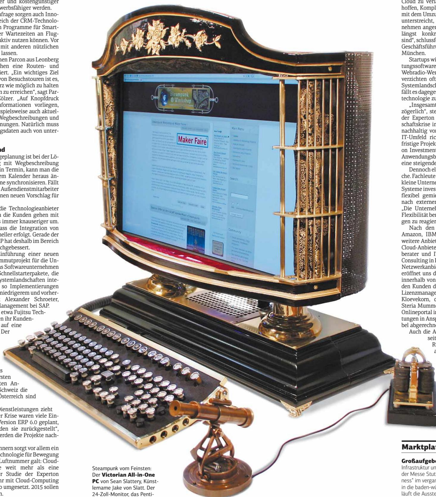
Steampunk vom Feinsten: Der **Victorian All-in-One PC** von Sean Slattery, Künstlername Jake von Slatt. Der 24-Zoll-Monitor, das Pentium-IV-Motherboard und das 250-Gigabyte-Laufwerk verschwinden in einer Vitrine vom Flohmarkt. Das Stromnetzteil steckt im schicken Standfuß
